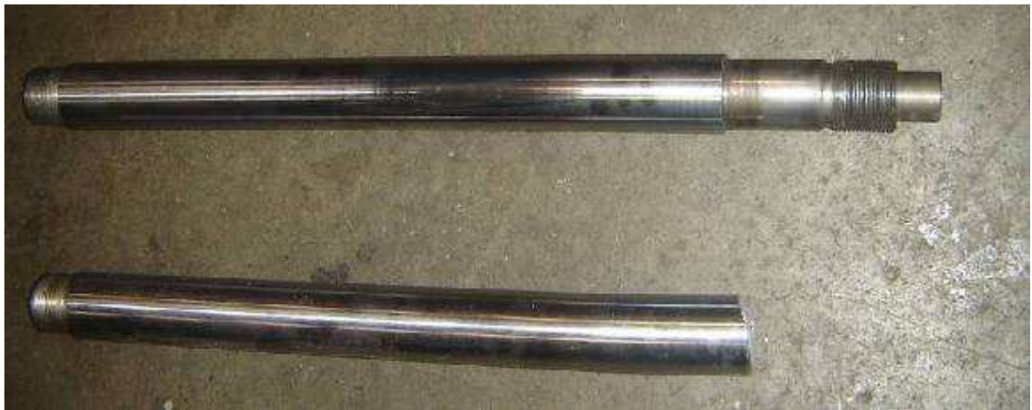
4 – Vistas parciais do eixo rompido.
