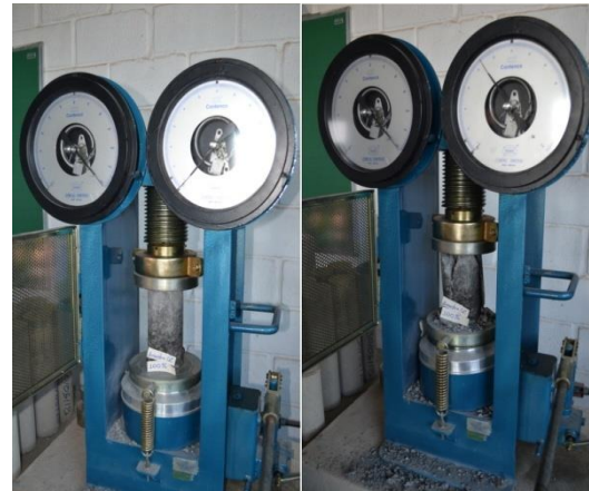
Figura 2 – Ensaio da amostra 02, corpo de prova com proporção de resíduo 100%
