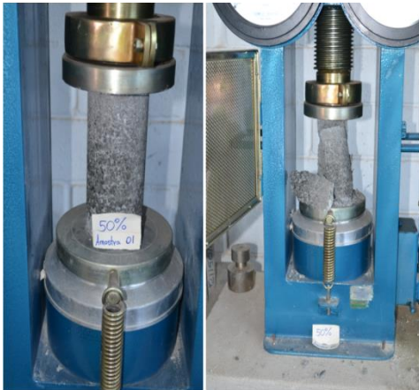
Figura 1 – Ensaio da amostra 01, corpo de prova com proporção de resíduo 50%
